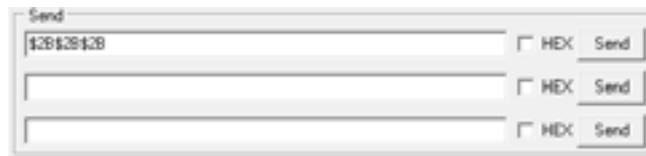
Envoyer la trame de passage en mode commande pour basculer le produit en mode de configuration, en cliquant sur le bouton SEND. Après quelques secondes, vous devez voir les 2 LEDs s'allumer de manière fixe. Sur le terminal port com, vous devez également avoir un retour d'information «CM» pour Command Mode.
